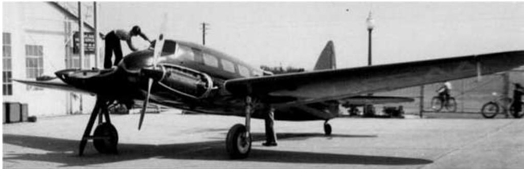
bessere Umströmung des Leitwerks durch die von den Propellern nach hinten gedrückten Luft zu erreichen, kippte man die Motoren um 3,5 Grad zur Längsachse. Ähnlich hatte man dies ja auch bei den beiden Außenmotoren der Ju 52/3m
